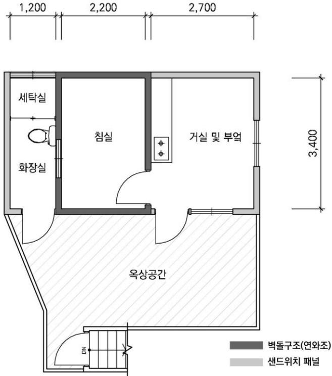
그림 4-8 옥탑방 평면도(용산구 용산동2가)
