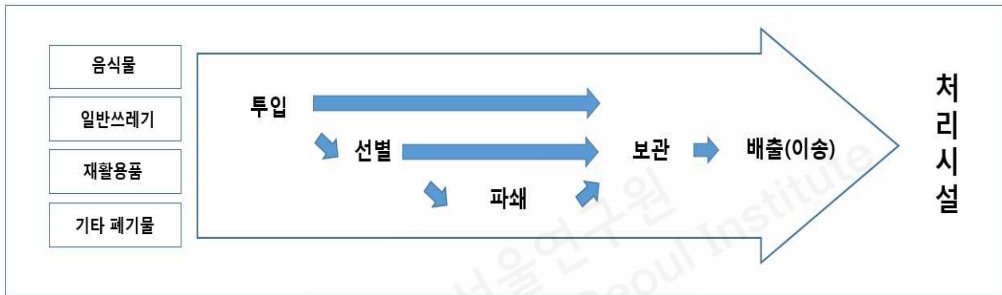
[그림 2-5] 적환장의 폐기물 보관 및 이송과정
