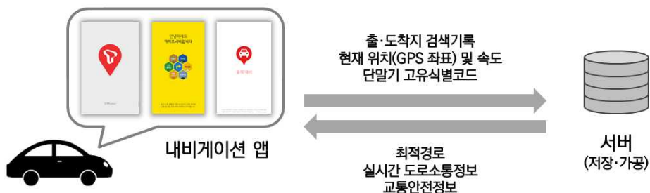
[그림 3-기] 내비게이션 애플리케이션 작동 시 정보의 흐름 예시
