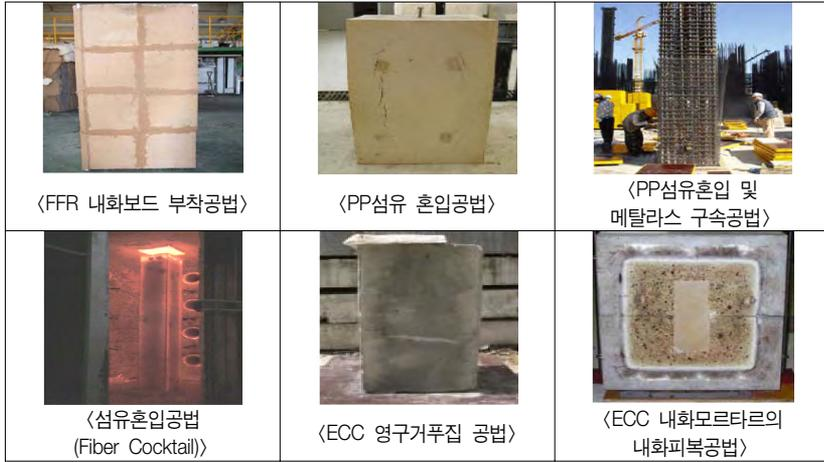
〈그림 4-25〉 국내 고강도 콘크리트의 폭렬대책 공법 현황
