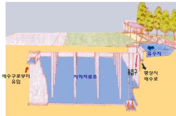
일본의 경우 비점오염원 및 CSOs가 하천에 그대로 유입되는 것을 방지하기 위하여 <그림 5-24>와 같은 시설들을 설치 또는 계획 중이며 실제로 나고야시
