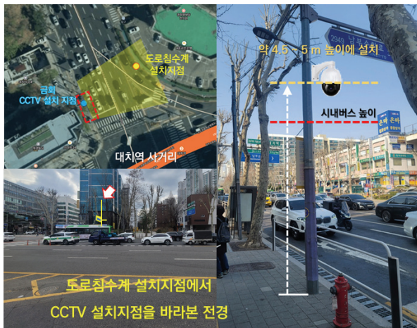
[그림 8] 학습 자료 수집을 위한 대치역 사거리 지점 CCTV 설치
