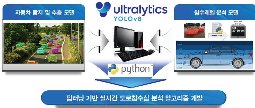
[그림 3] 도로침수심 분석 기술 개발 모식도
