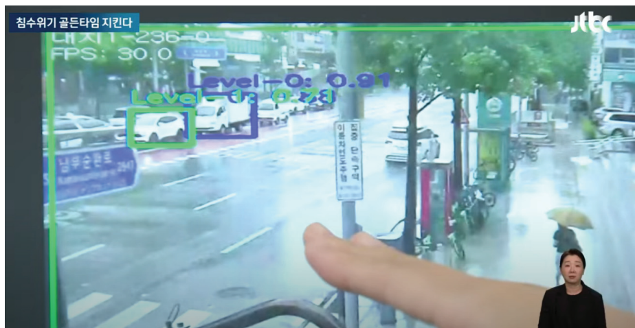
[그림 15] 대지역 사거리 지점 물 고임 현상으로 인한 침수 레벨-1 측정 화면(시범 운영 모니터링 화면)
