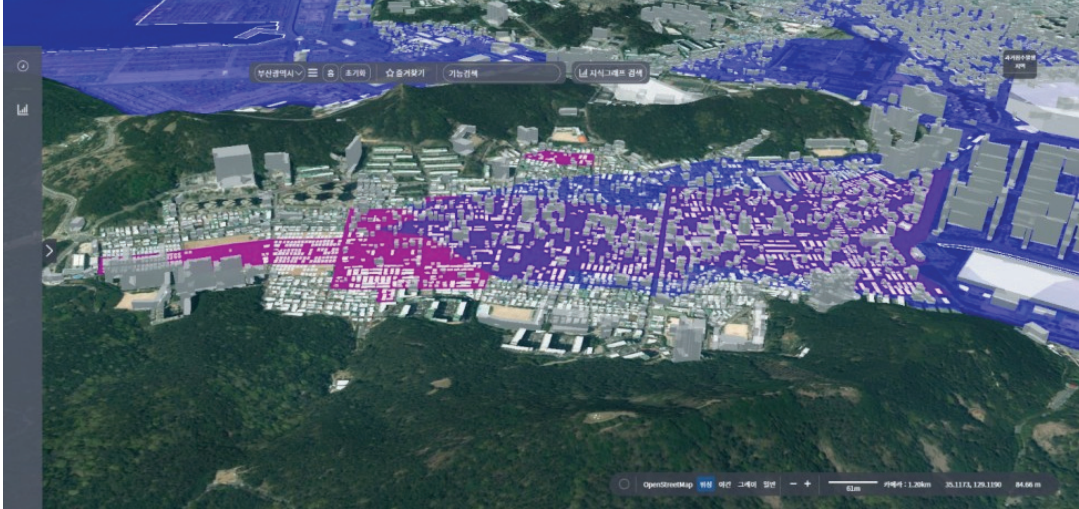
[그림 21] CCTV 기반 도시침수 모니터링 침수 지역 표출 예시
