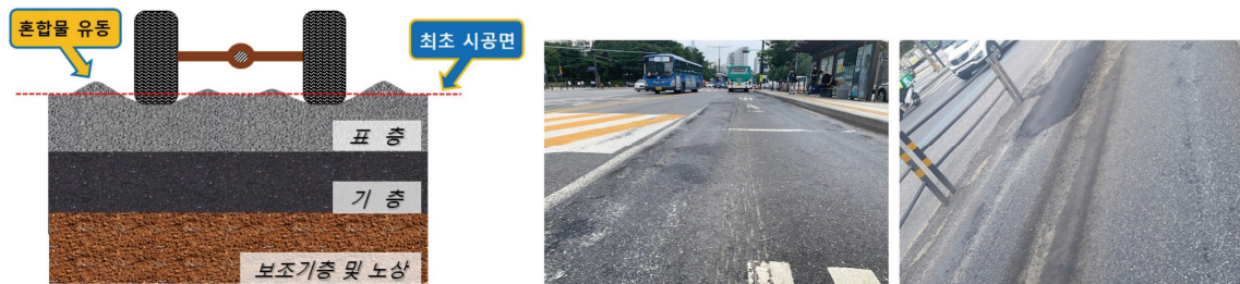
[그림 1] 재료적 측면 소성변형 발생 유형 및 서울시 발생 사례
