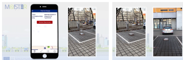
[그림] 스마트 주차 규제봉. 애플리케이션에 의해 규제봉이 자동으로 젖혀져 주차가 가능
