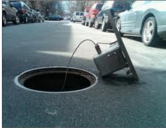
【맨홀 뚜껑에 설치되는 모니터링 센서】
