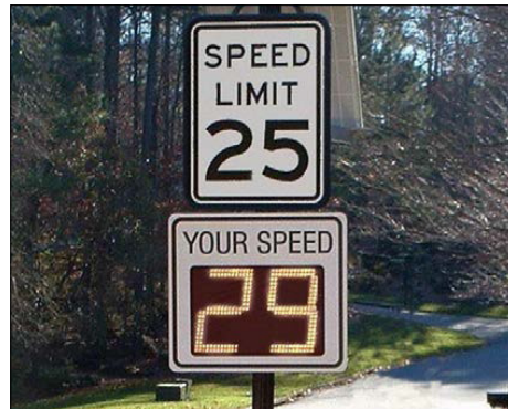
【주거지역에서의 규정속도를 줄이기 위한 도로설계안(왼쪽). 실제 운행속도를 운전자에게 알려줌으로써 속도 저감을 유도하는 방안(오른쪽)】
