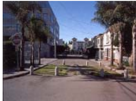
<그림 4> 차량의 통행을 제한하는 Forced Turn Island와 Full Closure
