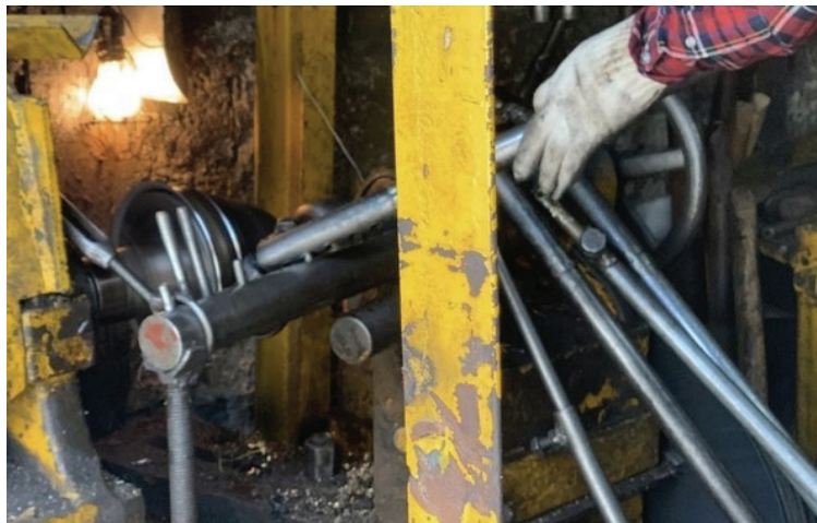
[그림 5-3] 소공인이 시보리 공정을 시연하고 있는 모습
