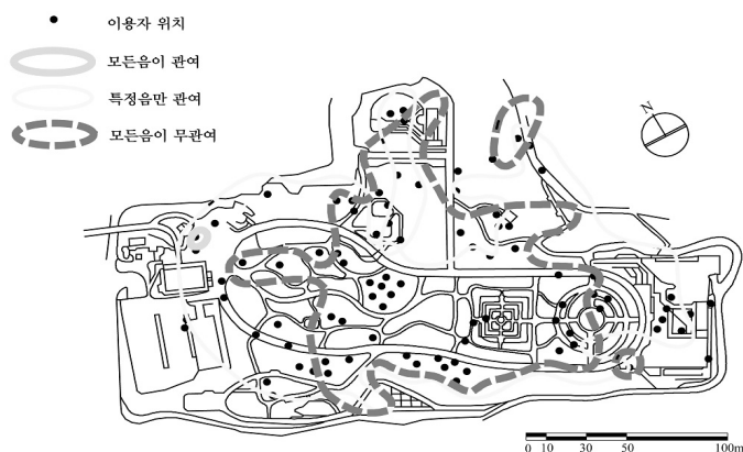
그림 4-12 후쿠오카 식물원의 사운드시스템 계획을 위한 분석도
