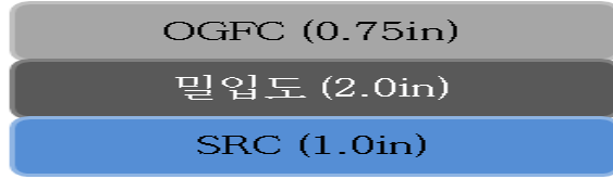
〈그림 3-12〉 Stress Relief Course 공법의 포장 단면
