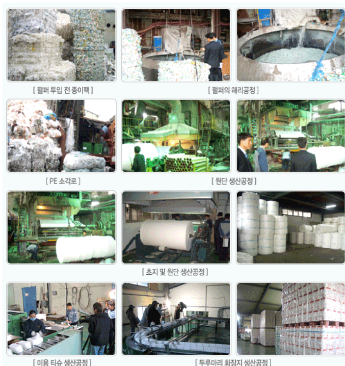
〈그림 3-2〉 폐종이팩을 이용한 화장지 생산공정의 예
