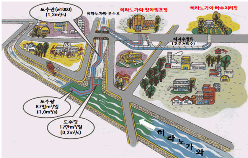
〈그림 2-28〉 오사카 히라노가와(平野川) 정화용수 도입 계통도
