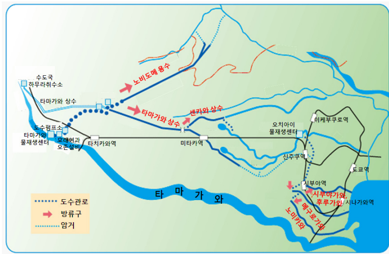
〈그림 2-26〉 타마가와(多摩川) 상류 물재생센터 처리수 공급 계통도
