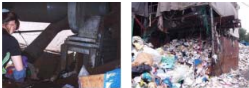
<그림 3-3> 구로구의 선별용 송풍장치(필름류 투입, 필름류 저장소)
