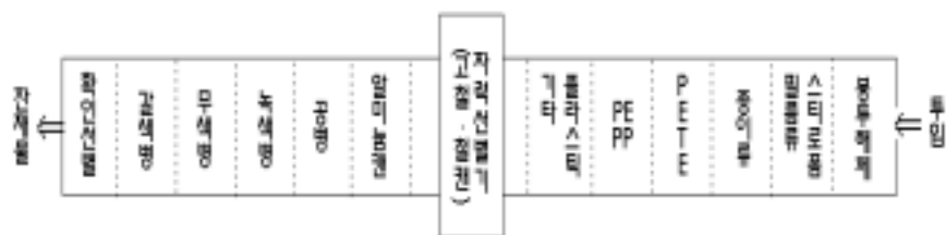
<그림 5-11> 인력선별 중심의 선별대에서 품목별 선별지점(예)
