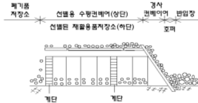
〈그림 4-10〉 선별플랫폼을 중심으로 한 반입장과 선별공정 모식도
