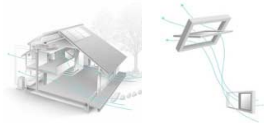
<그림 5.10> 창문 설치위치에 의한 건물의 통풍 방법
