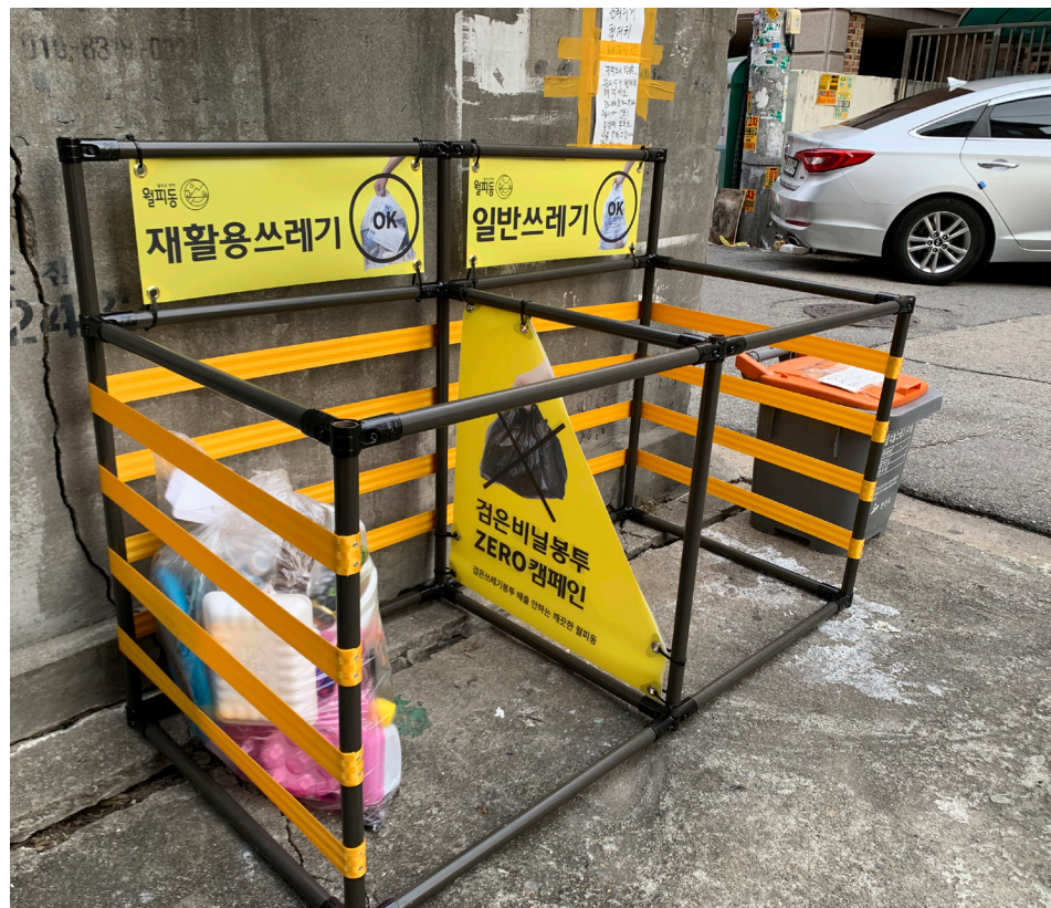
사진에 보이는 얇은 쇠파이프는 강관 비계 파이프보다 가볍고 덜 투박하다. 온라인에 '코팅 파이프'로 검색하면 파이프와 용접 없이도 초보자가 쉽게 사용할 수 있는 연결 조인트들이 많이 나온다. 비교적 저렴하게 분리수거대나 벤치, 기타 도시를 개선하기 위한 임시 시설물을 직접 제작할 수 있다. 사진: 첼리장
