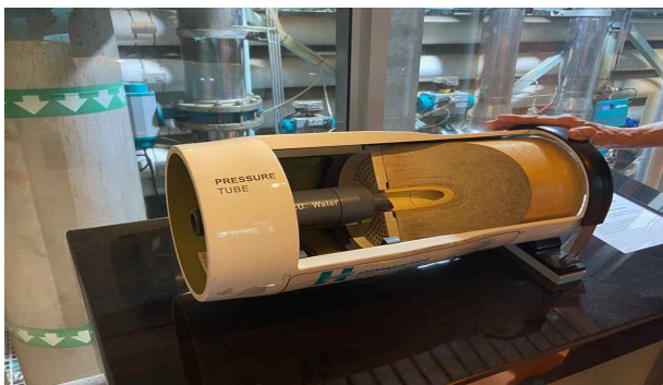
RO 수처리 장치
