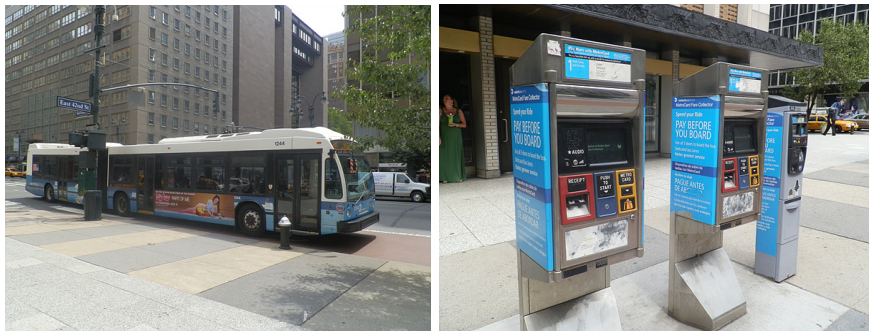
문이 3개 달린 SBS 저상굴절버스(좌), 2개의 카드요금정산기와 1개의 현금요금정산기로 구성된 SBS 버스요금징수시스템(우)
