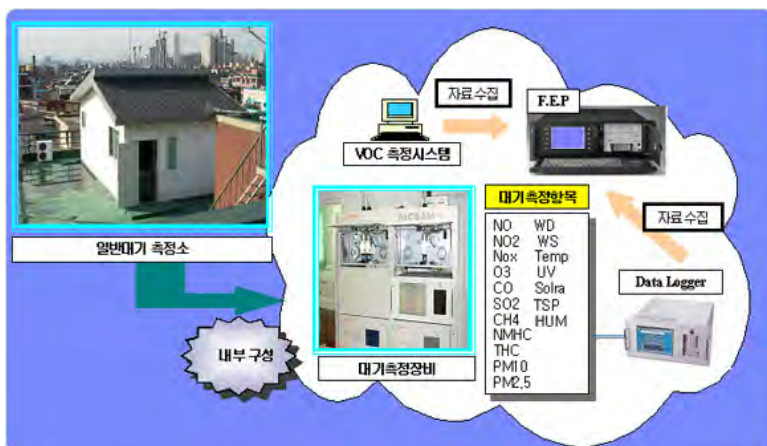
<그림 2-5> 대기측정자료 수집 및 전송체계
