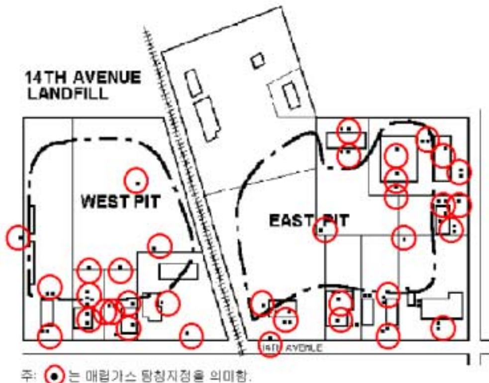
〈그림 6-1〉 캘리포니아 사크라멘토시의 매립지 토지이용에 따른 매립가스 모니터링 설치지점
