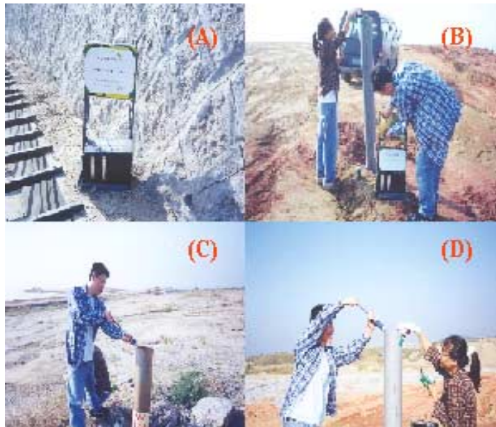
〈그림 4-2〉 제1매립지 사면(A) 및 상부·배출공(B,C,D) VOCs 측정(3차 및 4차측정)
