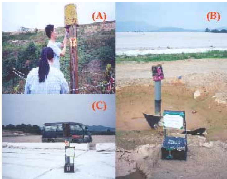
〈그림 4-3〉 제2매립지 사면(A) 및 상부·배출공(B,C) VOCs 측정(3차 및 4차측정)
