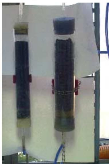
〈사진 3〉 활성탄과 지렁이분변토를 이용한 탈취장치
